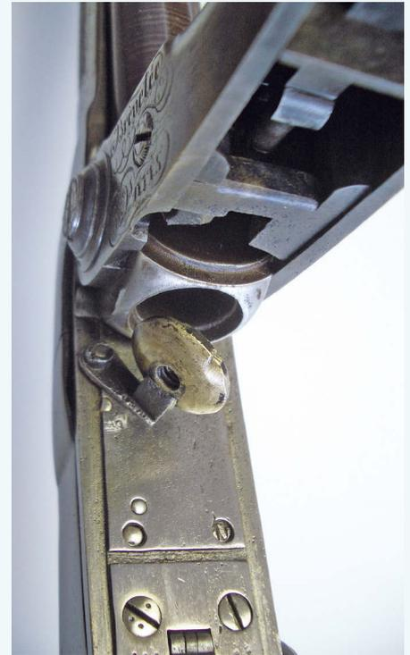
Der umgebaute Verschluss, bei dem die Messingrosette fix als Verschlussscheibe eingebaut ist, oben halb geöffnet, unten ganz offen.
