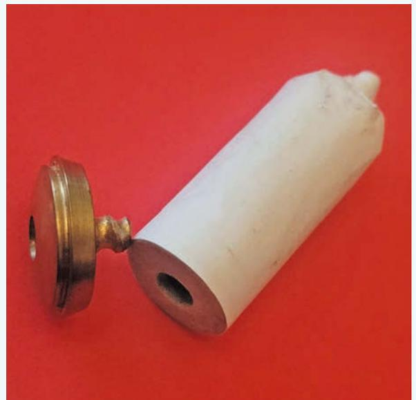
Pauly Patrone bereit zum Einschrauben der Messingrossette. Diese dichtete den Verschluss nach hinten ab und enthielt den Zündsatz. Nach dem Schuss war diese Messingscheibe wieder einsatzbereit.
